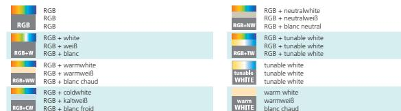
Die Farben der LED werden als Piktogramm (siehe unten) dargestellt, deren Lichtstrom direkt darunter. Der Lichtstrom wird in Lumen gemessen und gibt die erzeugte Lichtmenge der LED an. Je höher der Wert, desto heller das Produkt. Lichtstromangaben (Lumen) sind Platinen- bzw. Leuchtmittelwerte.
