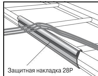
Устанавливайте Защитную накладку 28P для того, чтобы увеличить площадь контактной поверхности кабеля при протягивании через верхнюю кромку бокового профиля кабельной лестницы. Может обрезаться по месту при необходимости.
