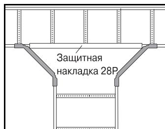
Для Т-секций, используйте два Угловых соединителя 14. Опорный кронштейн или консоль должны быть размещены под присоединяемыми лестницами вблизи места соединения. Рекомендуется использование Защитной накладки 28P, которая может резаться в нужный размер.
