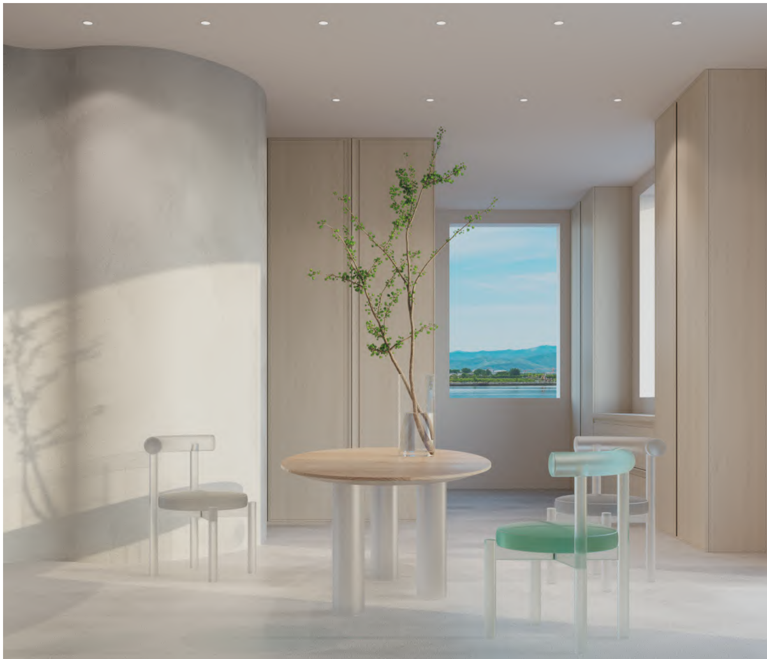
Утопленный источник света для антилепящего эффекта.
